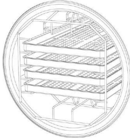
o, extrayendo el soporte portabandejas y girándolo 90°, puede ser usado para alojar "cajas" (3/4 compartimientos según el modelo de esterilizador).
