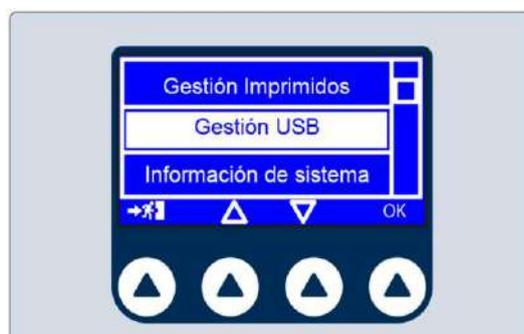
Al seleccionar DESCARGAR DATOS CICLOS, es posible copiar los datos relativos a los ciclos realizados, memorizados en la memoria interna del esterilizador, mediante un dispositivo USB.
