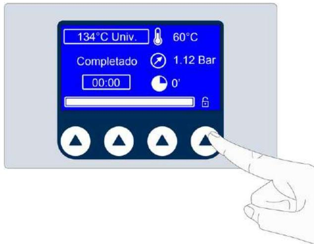
Al finalizar el ciclo, presionando la tecla indicada, se presenta la pantalla siguiente solo si está conectada la impresora al esterilizador con configuración impresión etiquetas (se configura desde la gestión impresiones). De lo contrario, el esterilizador imprime el informe automáticamente.
