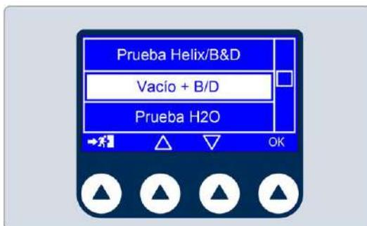
Para ello, colocar el dispositivo de prueba en la bandeja central, sin introducir otro material. Cerrar la puerta e iniciar el ciclo.
