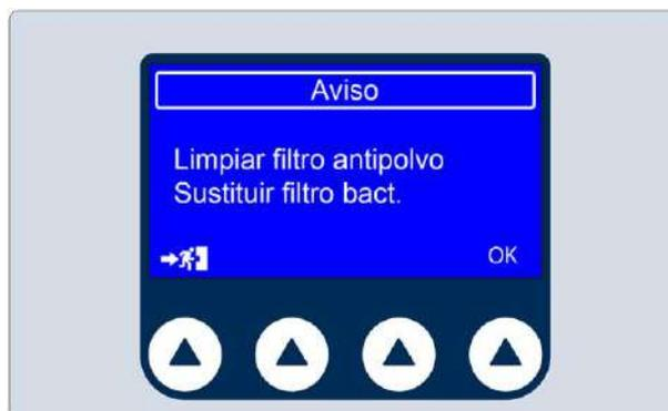
Presionar la tecla OK para confirmar que se ha efectuado la operación de mantenimiento prevista.
